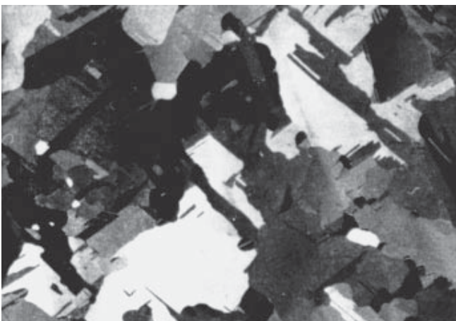
Grobkörniges Gefüge von PERMENORM 5000 H2
